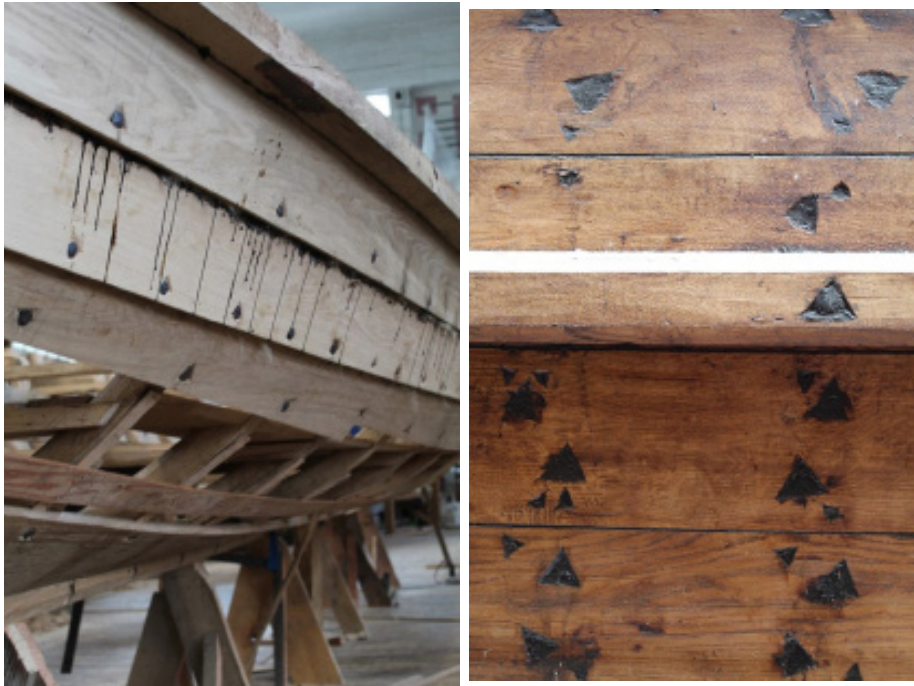
Figura 3 y 4. Figura 3 (Izquierda). Tracas a tingladillo y a tope (sujetas con clavos de forja en avellanado) durante el forrado de la chalupa auxiliar de la nao San Juan. Figura 4 (Derecha). Detalle de las tracas a tope en el forro de la nao San Juan, también con clavazón de forja con avellanado para la introducción de la cabeza y protección mediante cobertura con brea. Fuente: Fotografía de autor.
