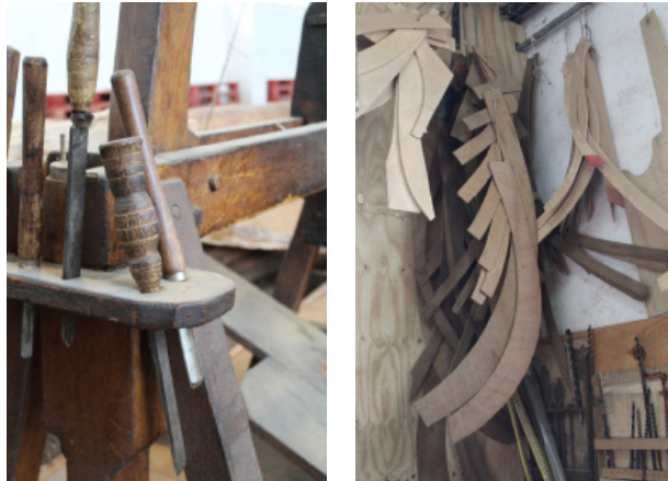
Figura 6 y 7. En la figura de la izquierda se presenta una variedad de formones como parte de la panoplia de herramientas del carpintero de ribera (foto de autor). Y en la de la derecha se muestra los juegos de gálibos colgados en el taller del astillero Albaola. Fuente: Fotografía de autor.
