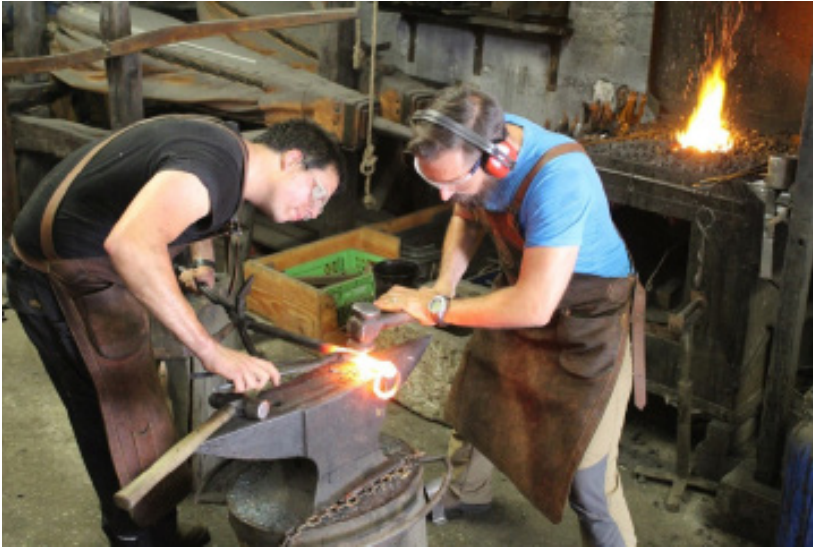
Figura 5. Jornada de trabajo en fragua del Astillero Albaola. Se pueden apreciar los elementos fundamentales de la forja tradicional: yunque, fuelle, fragua y herramientas. Fuente: Fotografía de autor.
